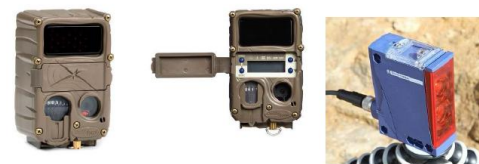
Figure 5. Photographie de la barrière infrarouge et du piège photos CUDEBACK © BIOTOPE, 2015 (source : CUDEBACK et JAMA)
