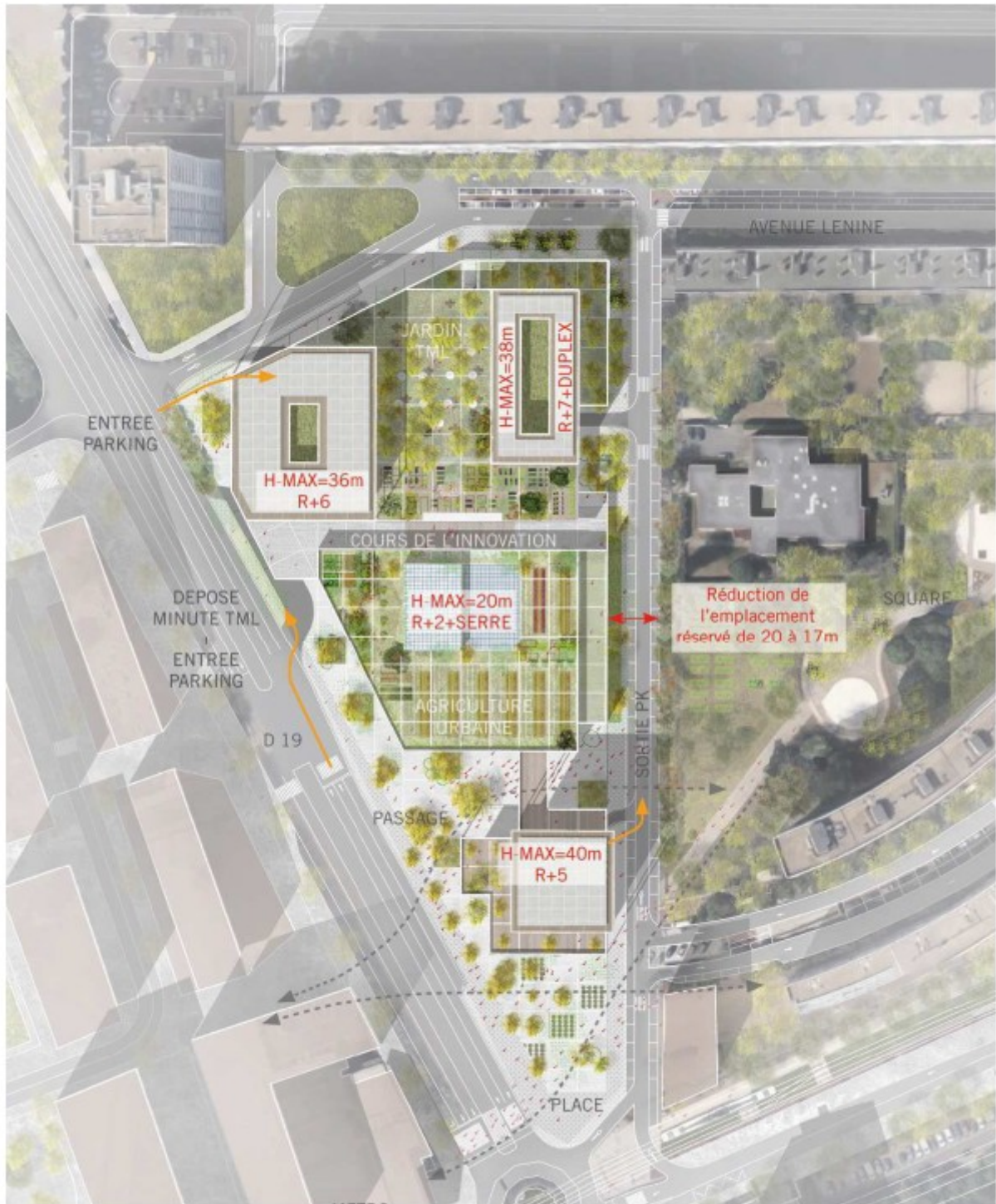
Illustration n° 4 - Plan masse du projet TML avec une enveloppe maximale de hauteur de 41 m - Source : Note de présentation - Modification simplifiée du PLU - p 23
