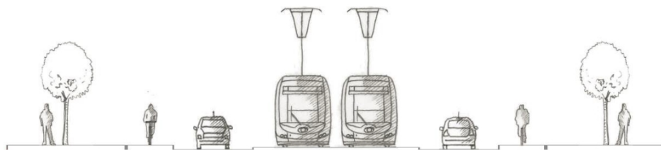
Illustration 3: Coupe-type d'une insertion axiale en section courante (hors station) - source : Chapitre II - Description du projet, p. 13
