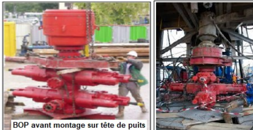
Illustration n°10 : Obturateur de puits – Source Compagnie française de géothermie
