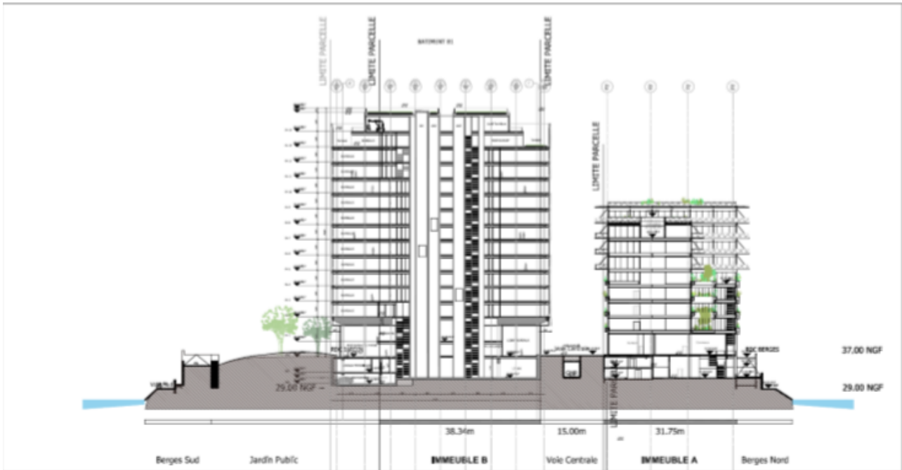
Illustration 7 : Coupe de principe au niveau des bâtiments A et B du projet (coté Meudon à gauche, côté Boulogne à droite) (pièce A02, p. 26)
