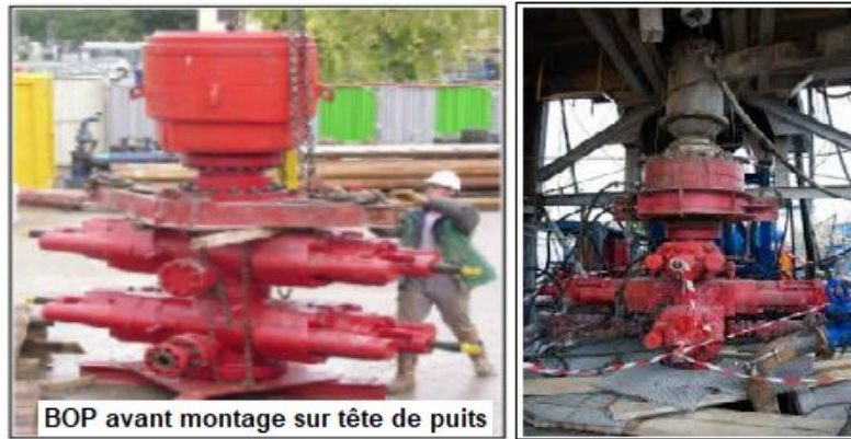
BOP avant montage sur tête de puits Illustration 9: obturateur de puits - source DRIEE
