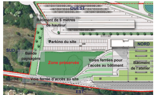
Figure 69 : Aménagement de l'atelier-garage autour de la zone préservée, garantissant d'aucune « ombre portée » ne viendra impacter le secteur (Source : AREP, 2013)
