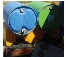
Photo 70 : Produits polluants stockés sur des bacs de rétention (Source : SYSTRA, 2012)
