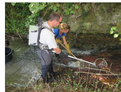
Figure 11 : Porteur d'anode, d'une épousette, de la poubelle et de l'épousette (©Fédération de Seine-et-Marne pour la Pêche et la Protection du Milieu Aquatique).
