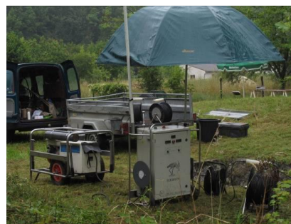
Figure 10 : Matériel de pêches électriques, au premier plan, à gauche, le groupe électrogène et à droite le boîtier servant à fournir le courant redressé (© Fédération de Seine-et-Marne pour la Pêche et la Protection du Milieu Aquatique).
