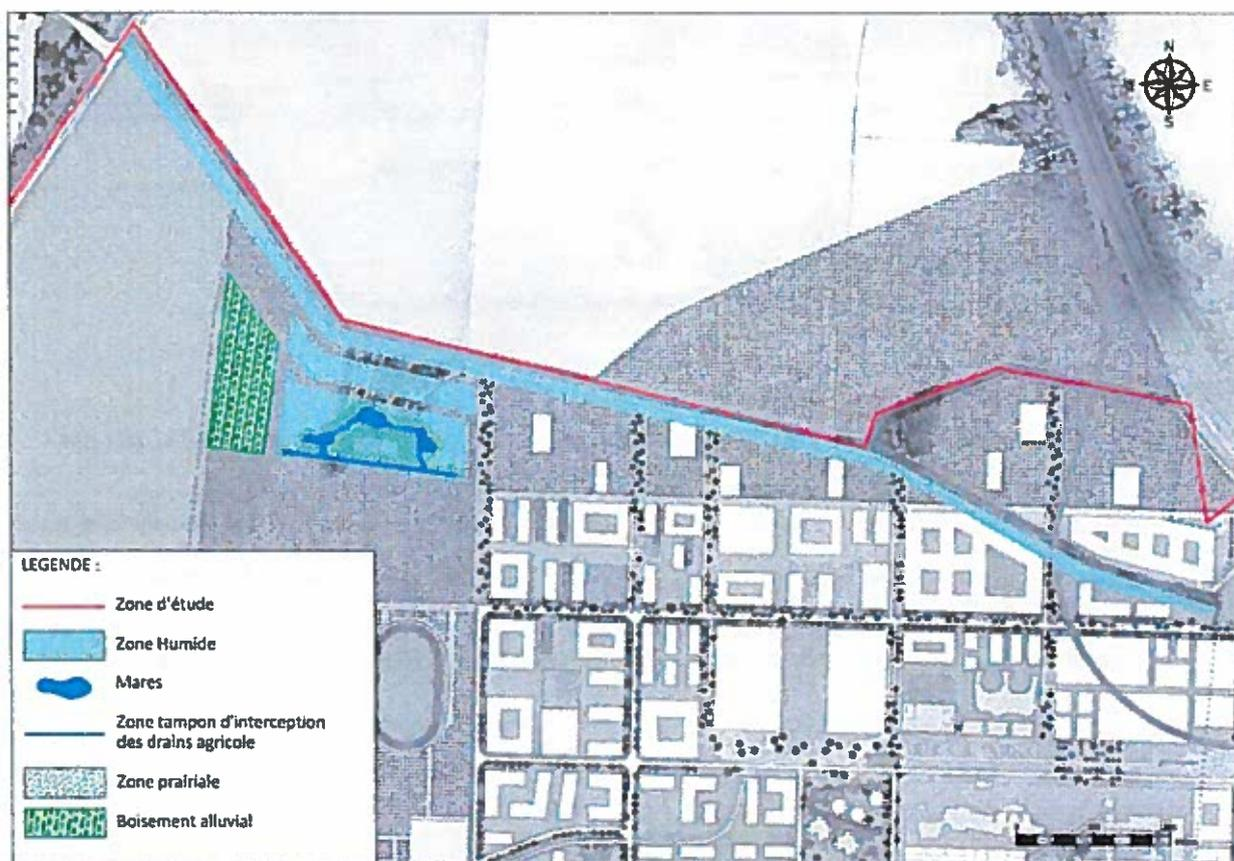
Figure 48 : Schéma d'implantation de 3 mares dans la zone humide créée en prolongement de la rigole de Corbeville
