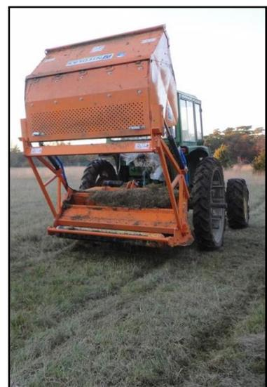
Figure 4. Le gyrobroyeur-exportateur.
