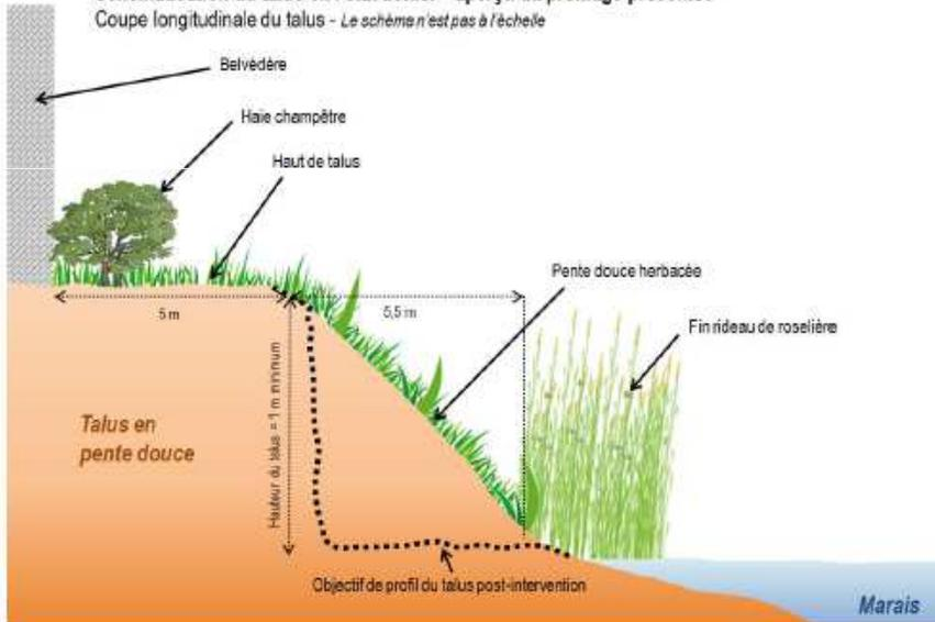
Coupe longitudinale du talus concerné par l'opération en l'état actuel avec projection du modelage à réaliser (en pointillés) - ECOTER 2017
