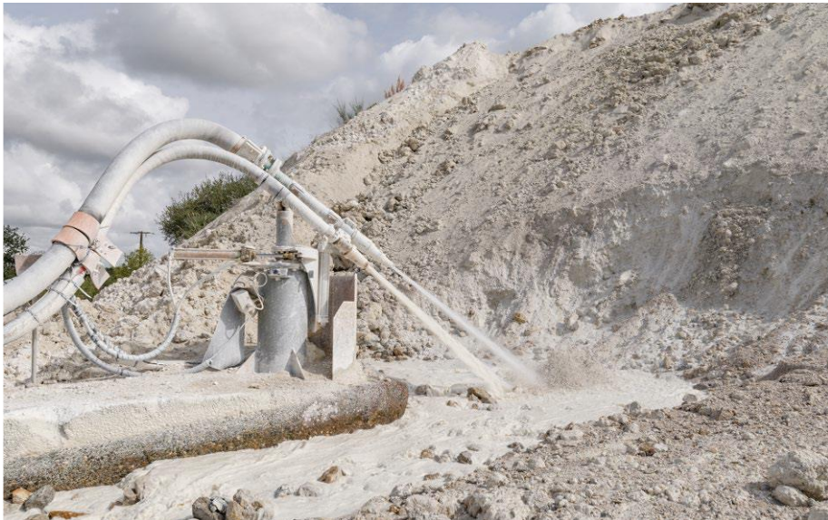
Le délayage : lavage du minerai brut se faisant à l'aide de grosses lances à pression d'eau. Cette étape permet d'éliminer les gros grains de quartz de la terre brute
