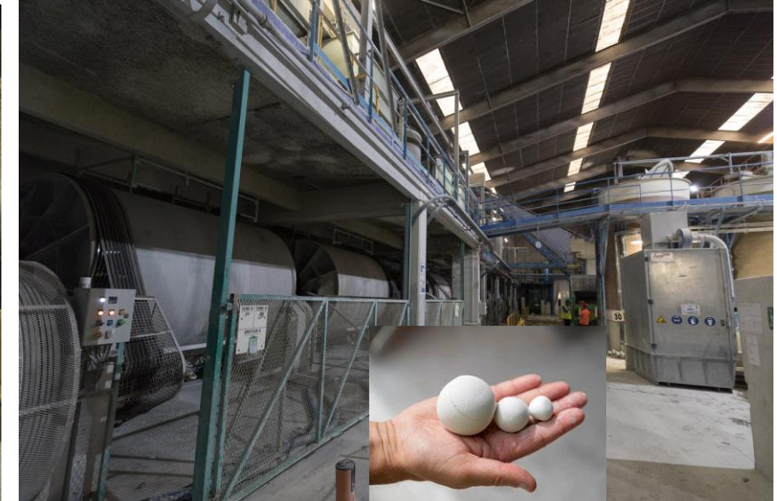
Différents procédés ou outils de fragmentation sont utilisés pour réduire les matériaux à la dimension recherchée pour l'usage final, depuis le concasseur à mâchoire, les broyeurs à marteaux ou à impact, les broyeurs à boulets ou les broyeurs à jets d'air, pour ne citer que les plus courants. Chaque appareil a sa spécificité d'application
