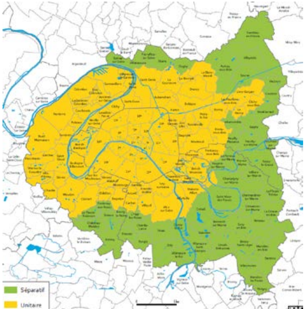
Types de réseaux d'assainissement dominants sur le territoire du Grand Paris Sources : CG92, CG93, CG94 et DPE
