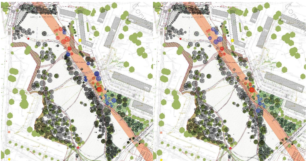
FIGURE 48 : A GAUCHE : TRACE DES EP (14 ARBRES ABATTUS, 19 ELAGUES) ; A DROITE : IMPACT DE L'OFFRE RETENUE A L'ISSUE DU MGP (10 ARBRES ABATTUS ET 14 ELAGUES)
