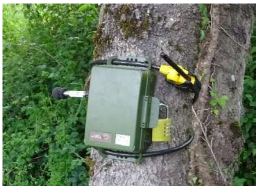
Photo 32 : Installation d'un enregistreur à ultrason SM4
