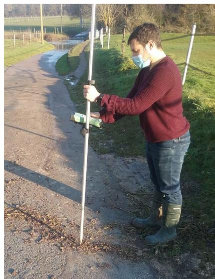
Nivellement au GPS d'une laisse de crue (dépôt de végétation en travers de la route)
