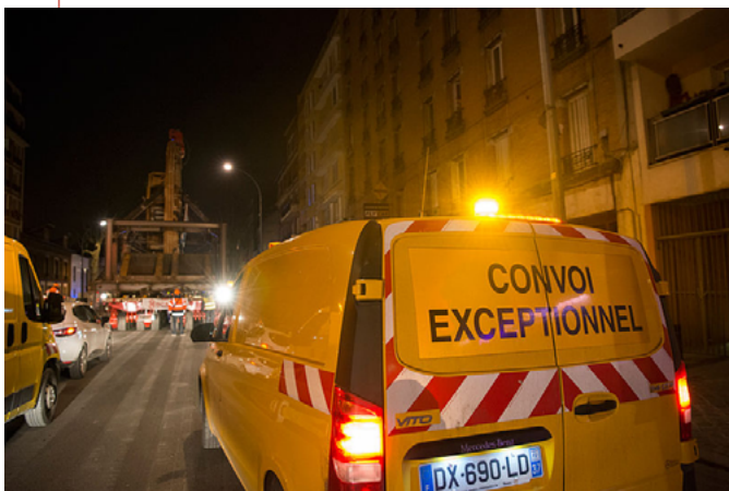
Transport de la roue de coupe de Tunnelier entre Saint-Ouen et Saint Denis en 2016 - Masse totale roulante de 432 t 600 | Crédits photos : DRIEAT
