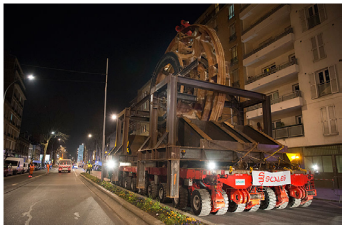
Transport de la roue de coupe de Tunnelier entre Saint-Ouen et Saint Denis en 2016 - Masse totale roulante de 432 t 600 | Crédits photos : DRIEAT
