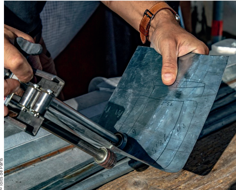
Ci-contre : la malléabilité d'une feuille de zinc fait qu'elle peut être facilement façonnée avec les outils appropriés, voire même à la main. Ci-dessus : on peut obtenir des détails très fins dans la sculpture du zinc.
