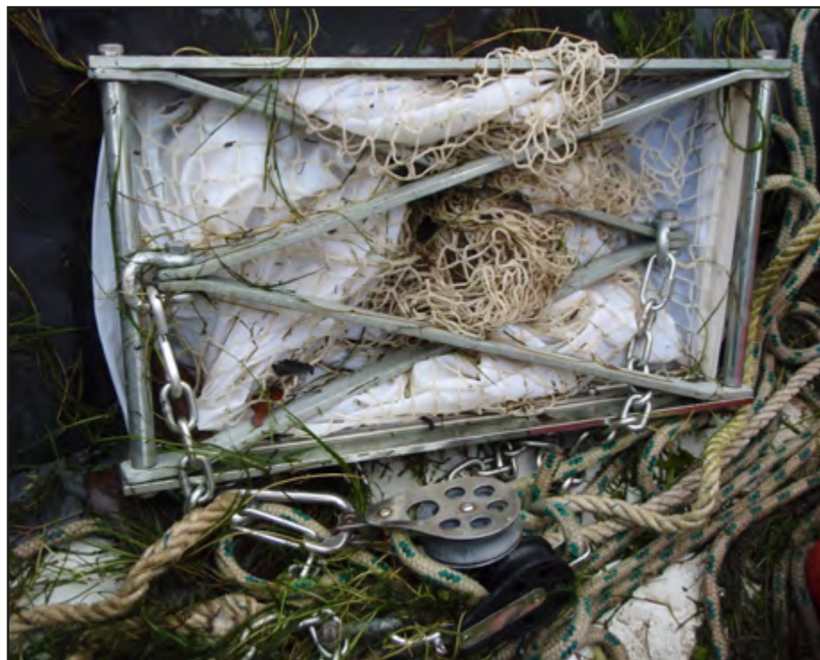
Figure 17 : Aperçu d'une drague adaptée à la capture de Mulettes (crédit photo : Xavier Cucherat).
