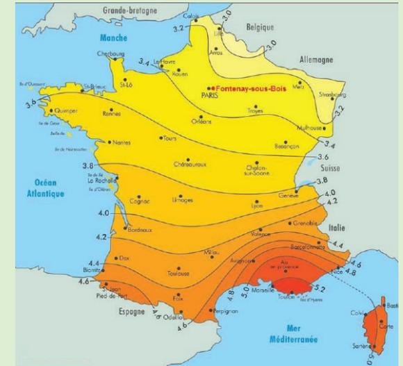
Moyennes annuelles de l'énergie reçue sur une surface orientée au sud et inclinée d'un angle égal à la latitude (en kWh/m<sup>2</sup>.jour) (Source : Tecsol)
