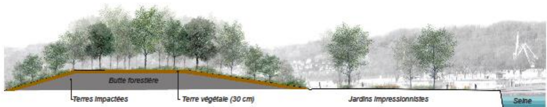
Coupe de principe de constitution de la butte
