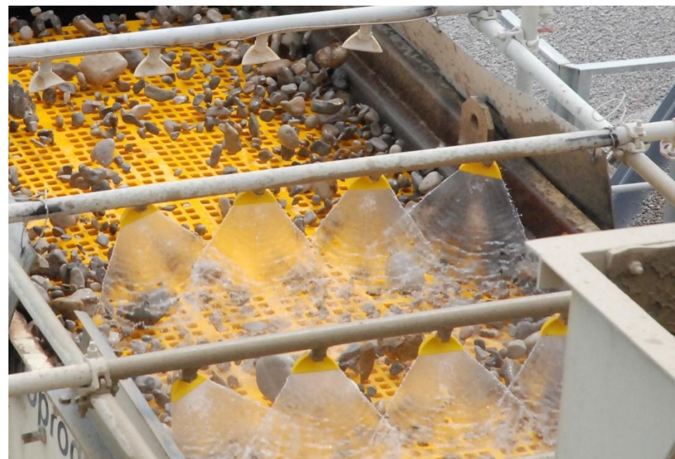
Figure 15 : Le traitement des granulats pour permettre d'obtenir des granulats répondant à des spécifications bien précises (photo : E. Fromentin – UNICEM).
