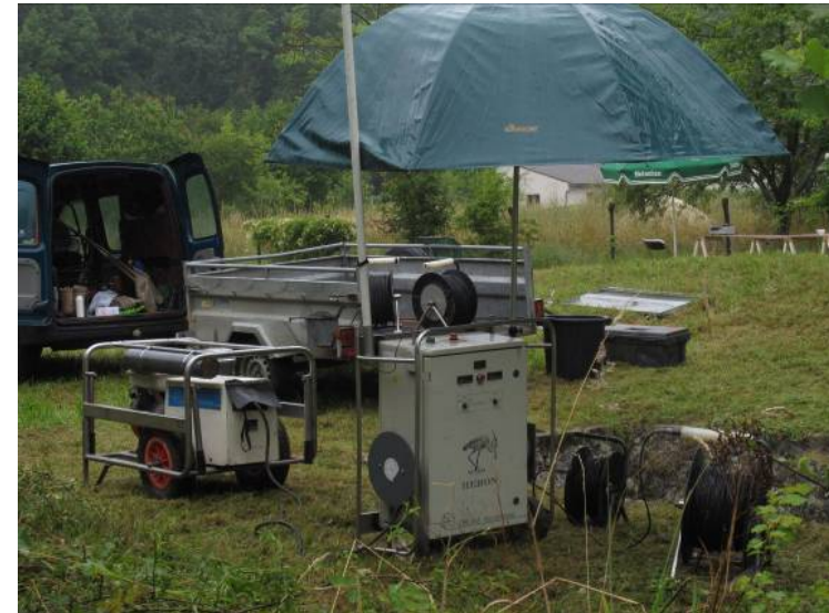
Figure 2 : Matériel de pêche électrique, au premier plan, à gauche, le groupe électrogène et à droite le boîtier servant à fournir le courant redressé (Source : Fédération de pêche de Seine et Marne)
