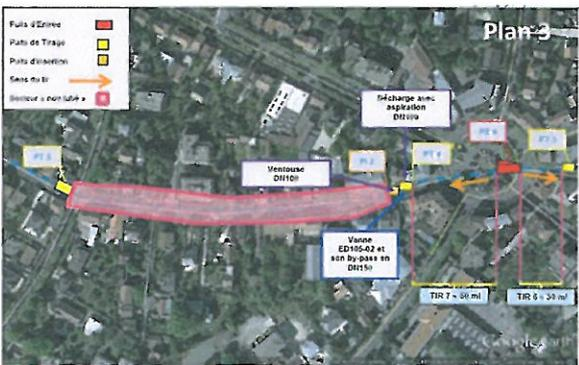
Figure 18 - Détail du tubage du bief 080-03-26 (Rond-Point de Montfermeil)
