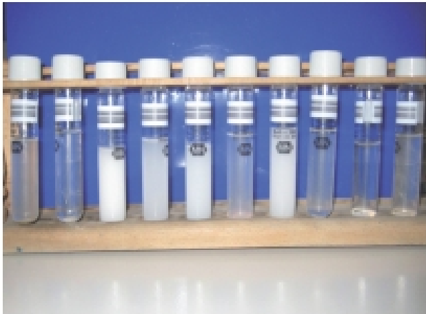
Tests de sulfate
