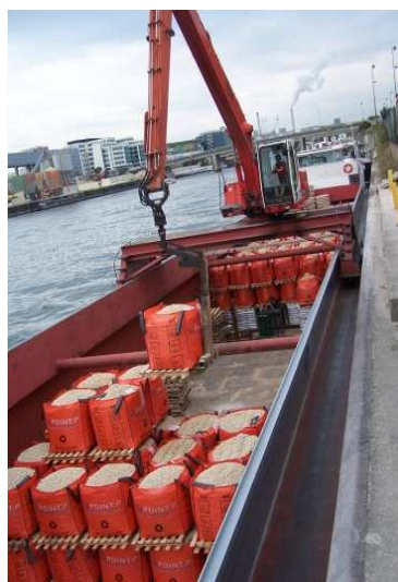
Déchargement de « big-bags »
