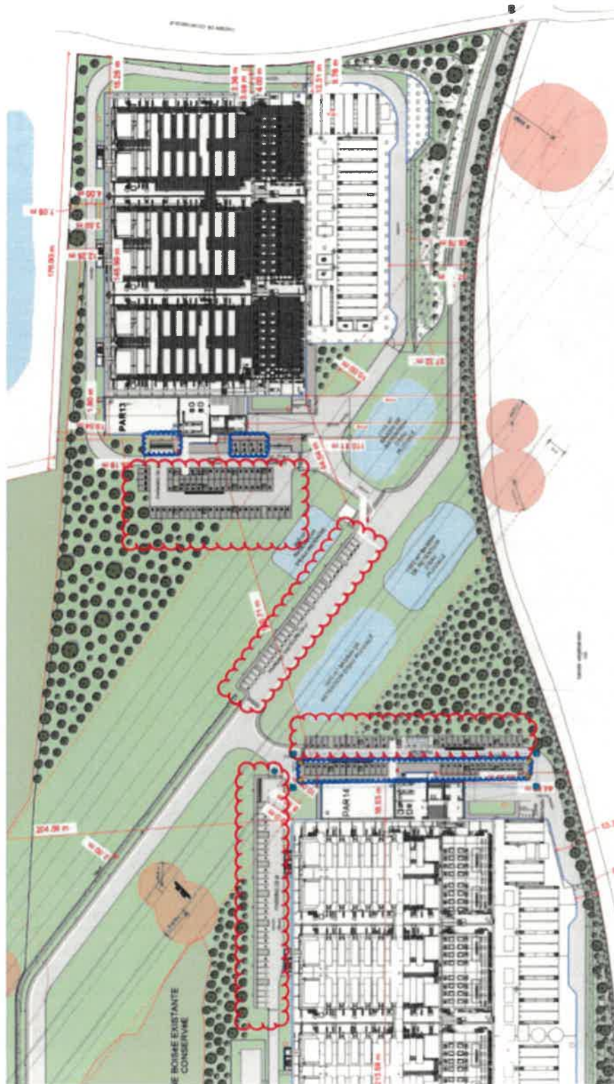
Extrait du plan de masse et stationnements perméables (rouge) / imperméables (bleu) (source : Reid Brewin Architectes)
