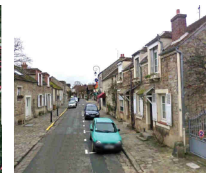
Constructions mitoyennes s'isolant les unes les autres. Lorsque les combles ne sont pas aménagés, ils constituent des espaces tampons isolant l'étage habité
