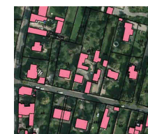
A l'intersection des rues Charles Jacques et du 23 Août 1945 : l'abandon de la mitoyenneté et de l'orientation Nord/Sud favorise les déperditions d'énergie.
