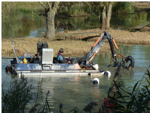
Vue de la barge (aspiration sédiments transportés par tuyaux flottants). © DNPB-CG93
