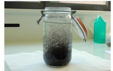
Mise en suspension du bocal : les particules sédimentent successivement selon leur densité.
