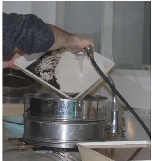
Tamisage de C2 sur une colonne de tamis 1 mm et 0.5 mm.
