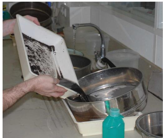
Filtration de C1 : solution de sucre contenant les éléments non flottants de l'échantillon.
