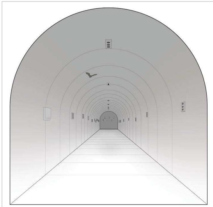
Figure 114. Schéma de principe (perspective) d'aménagement des dispositifs en faveur des chiroptères dans le bâti.
