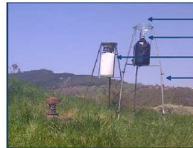
Entonnoir Jauge en verre protégée de la lumière Jauge en plastique Support métallique
