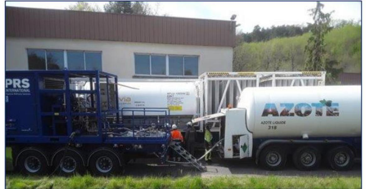
Exemple d'installation de moyens de balayage azote
