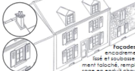
Façades : encadrement lissé et sous-bassement taloché, remplissage en enduit chaux gratté ou à pierres vues joints chaux.
