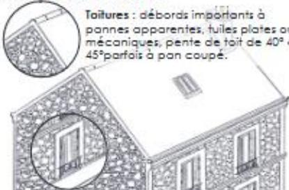
Fenêtres : encadrement plâtre lissé ou à joints creux pour imitation pierres de taille, garde-corps en fer forgé et volets métal repliés à persiennés.
