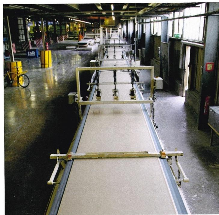
Figure 20 : Ligne de production de plaques de plâtre de Saint-Soupplets (source Knauf, panorama des minéraux et matériaux industriels en Île-de-France).
