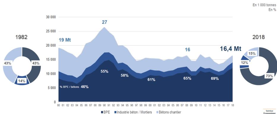
Figure 40 : Evolution de la demande en granulats pour la filière béton depuis 1980 et la part dans ces différents usages (données UNICEM).
