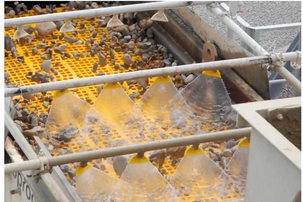
**Figure 13 :** Le traitement des granulats pour permettre d'obtenir des granulats répondant à des spécifications bien précises (photo : E. Fromentin – UNICEM).
