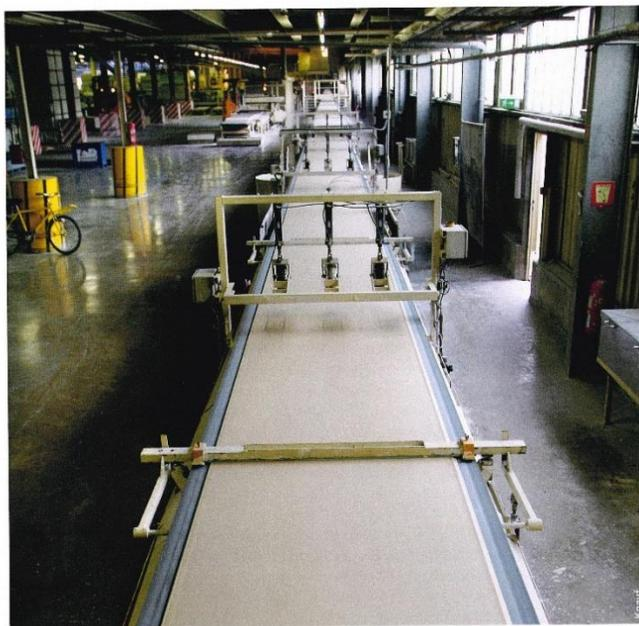
**Figure 18 :** Ligne de production de plaques de plâtre de Saint-Souplets (source Knauf, panorama des minéraux et matériaux industriels en Île-de-France).
