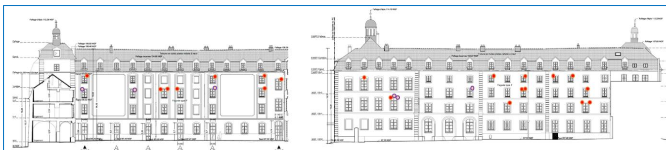
Repérage sur le Bâtiment Villars, faces Est et Ouest (20 occupés - 6 endommagés/inoccupés)
