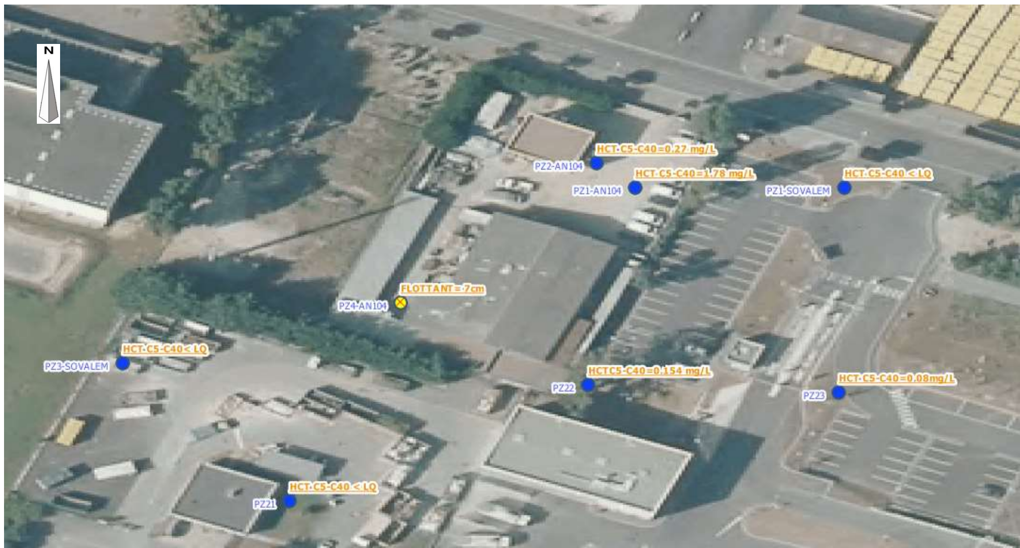
Carte des teneurs en hydrocarbures C 5 -C 40 (LQ : limite de quantification du laboratoire)
