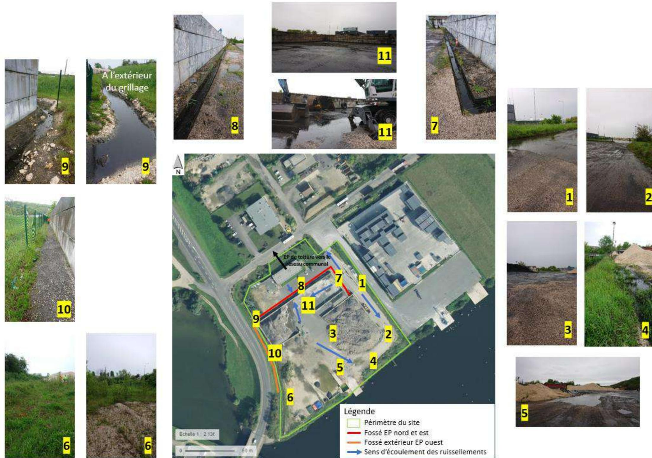
Figure 3 : Carte de la gestion actuelle des eaux pluviales et photographies du fossé aménagé en limite extérieure ouest du site et du fossé longeant le muret de la plateforme (source : Fond de plan orthophotographie avec annotations GINGER BURGEAP)
