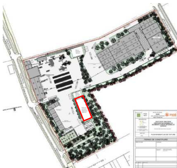
Localisation du bassin de rétention des eaux d'extinction en rouge
