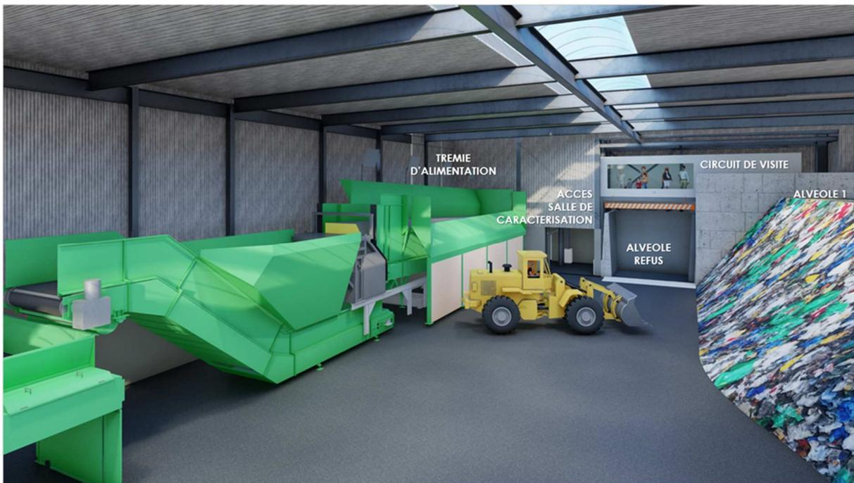
Figure 12 : Représentation dans la future zone d'alimentation de la chaîne de tri
