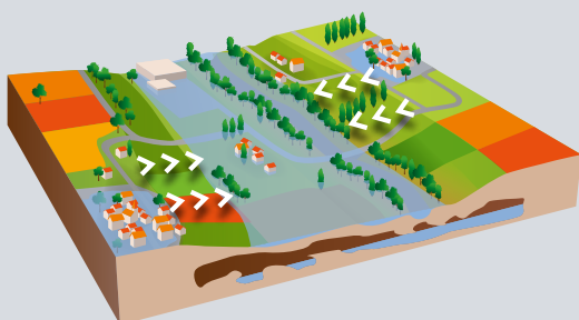
Inondation par ruissellement pluvial
