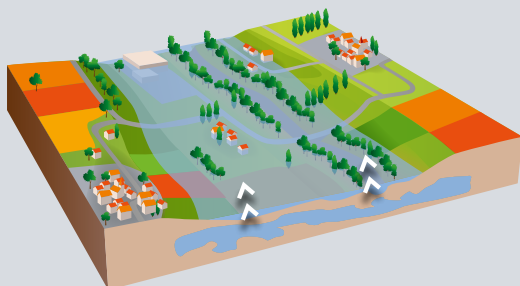
Inondation par remontées de nappes
