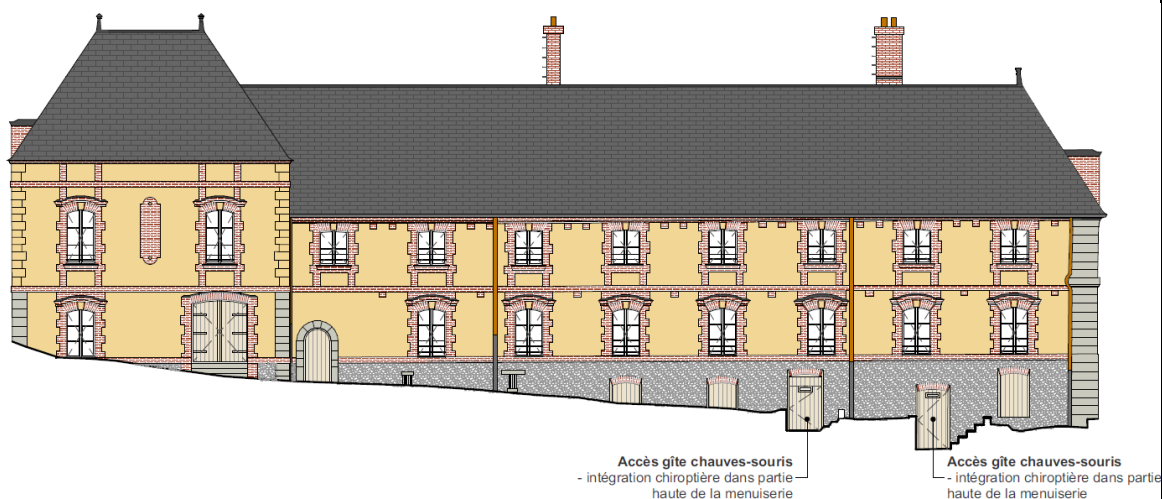
Figure 47. Façade ouest de l'aile ouest des communs avec position des deux accès aux caves pour les chauves-souris et pour le suivi
