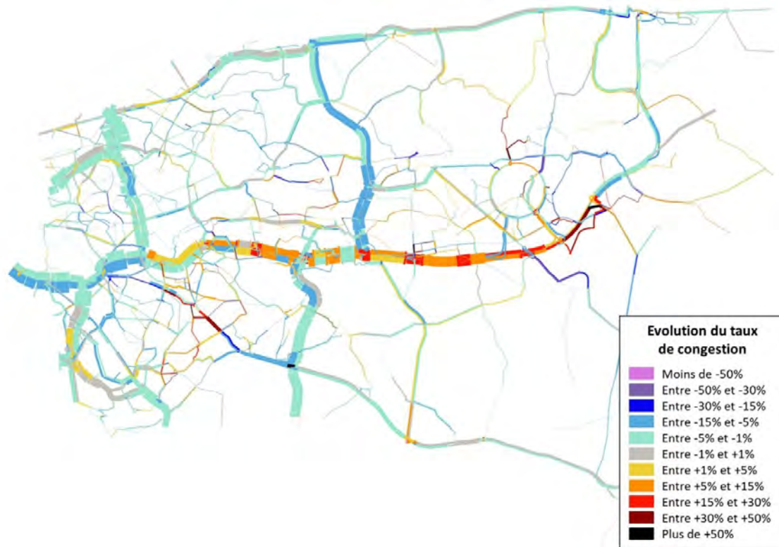
Figure 149 - Evolution du taux de congestion entre le scénario 1 en 2025 et le scénario 11 en 2035 - heure de pointe du soir
