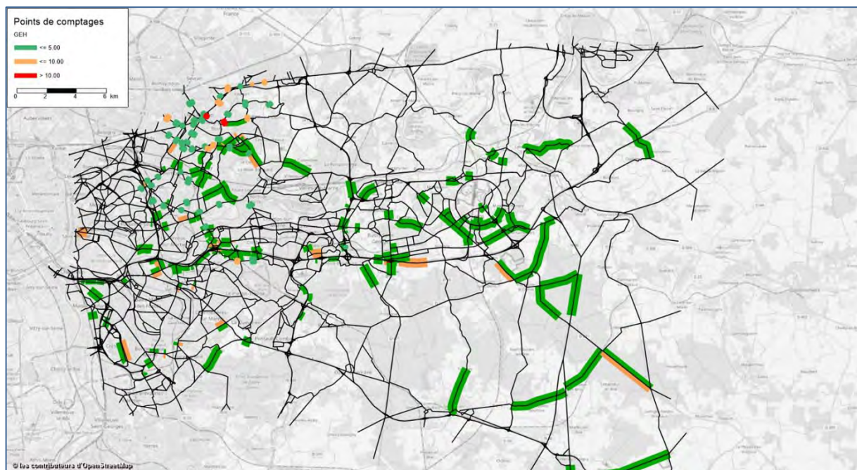
Figure 115 - Qualité de la cohérence entre les flux modélisés et les flux observés (comptages)
