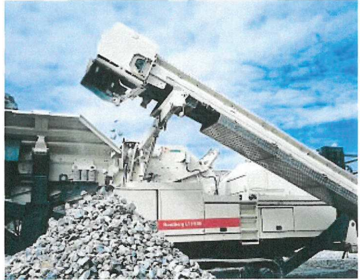
Deux produits finis peuvent être obtenus grâce à une exploitation en circuit ouvert.
