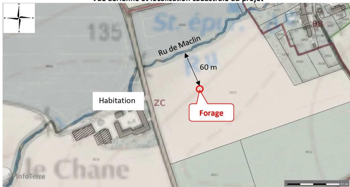
La nappe du Champigny est trop profonde pour faire subir au réseau hydrographique une quelconque incidence due au prélèvement au droit de la nappe. De plus une cimentation sur 30 m est réalisée et renforcera la déconnection naturelle (argile de surface).
