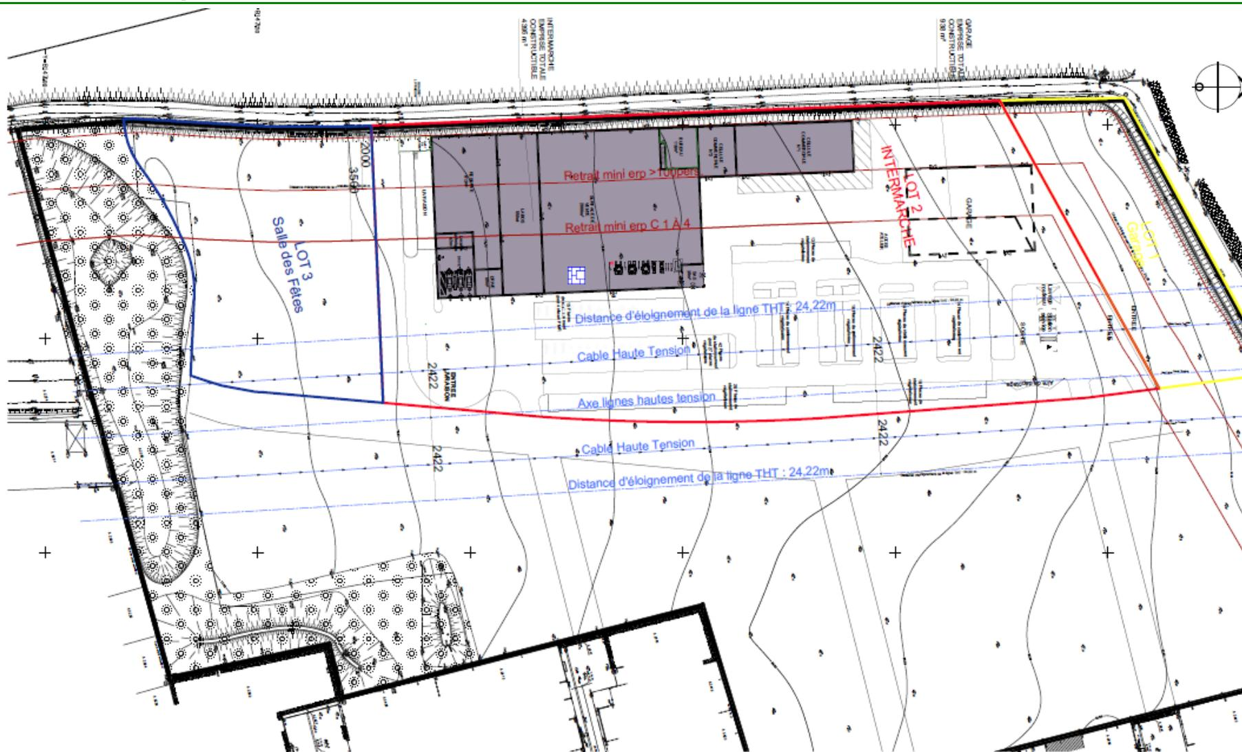
Plan masse du projet : implantation des bâtiments, distances à la ligne RTE et à la canalisation de gaz
