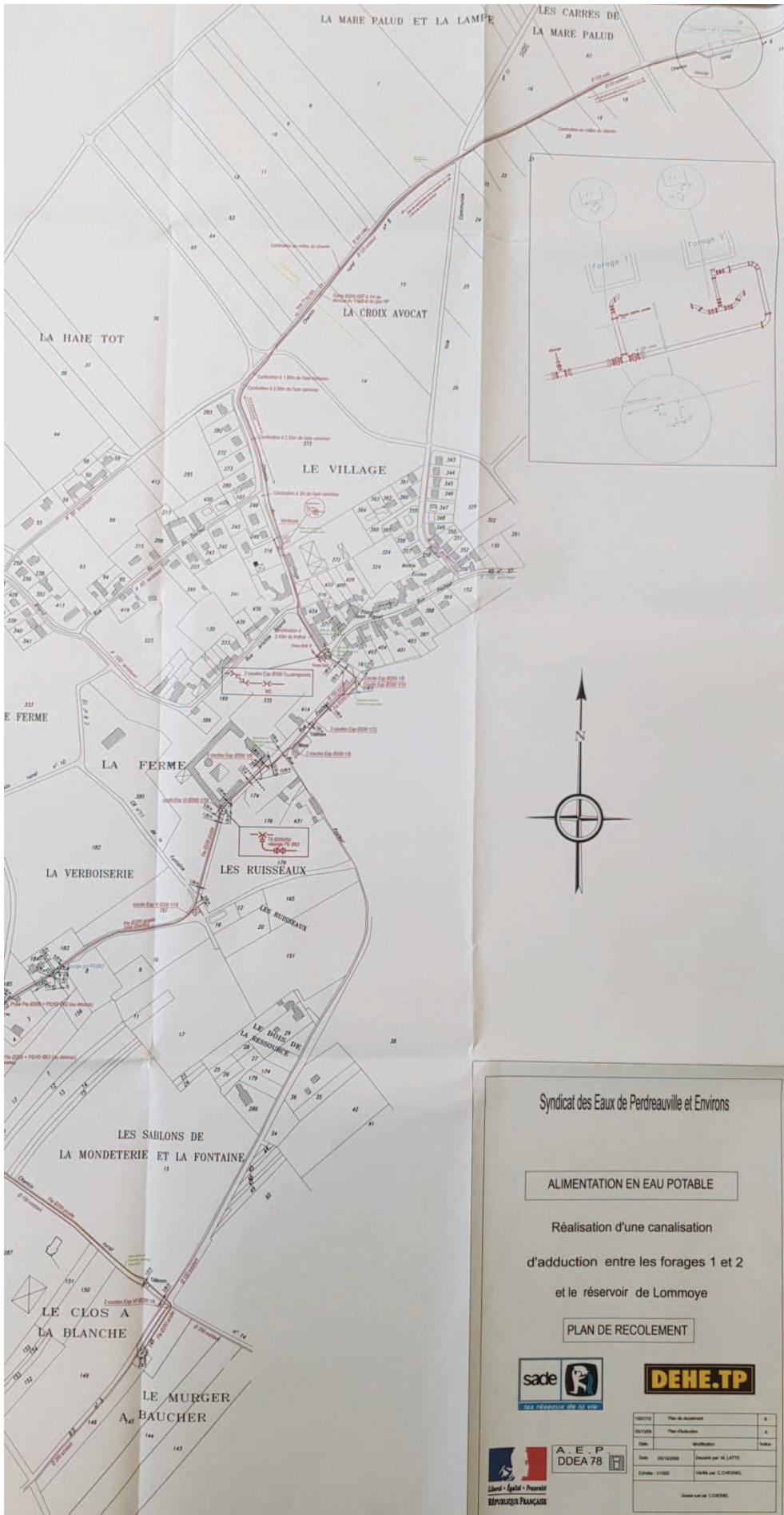
Plan de raccordement du forage F2 (et F1) au réservoir semi-enterré Lommoye
