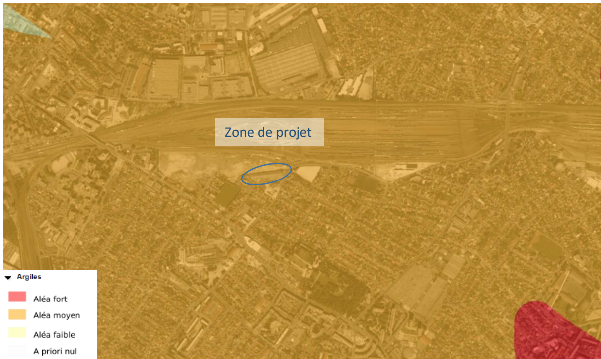
Risques liés au phénomène de retrait-gonflement des argiles (Source : Géorisques)
