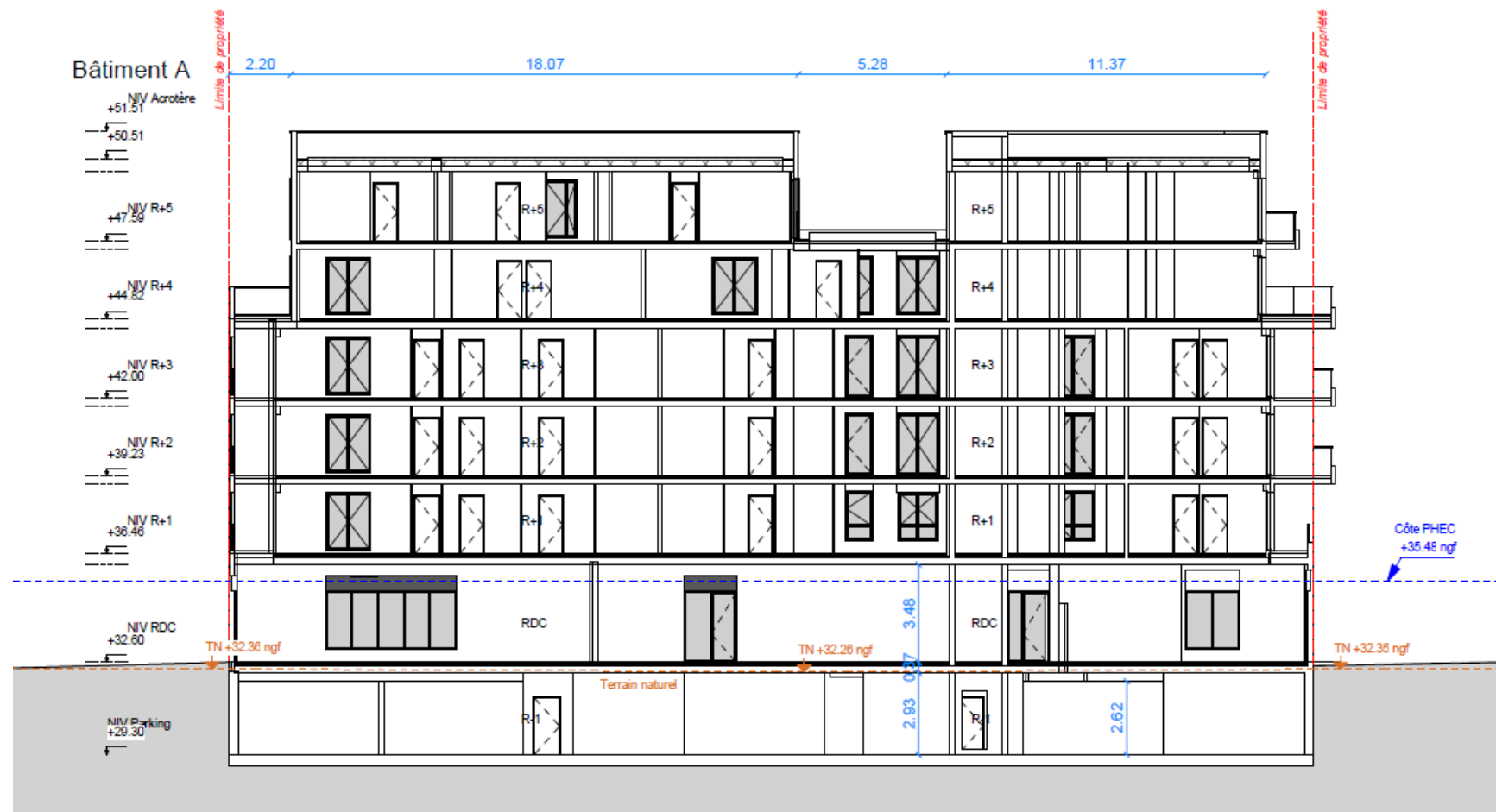
Figure 14 : Coupe transversale – Bâtiment A (Lot 2)
