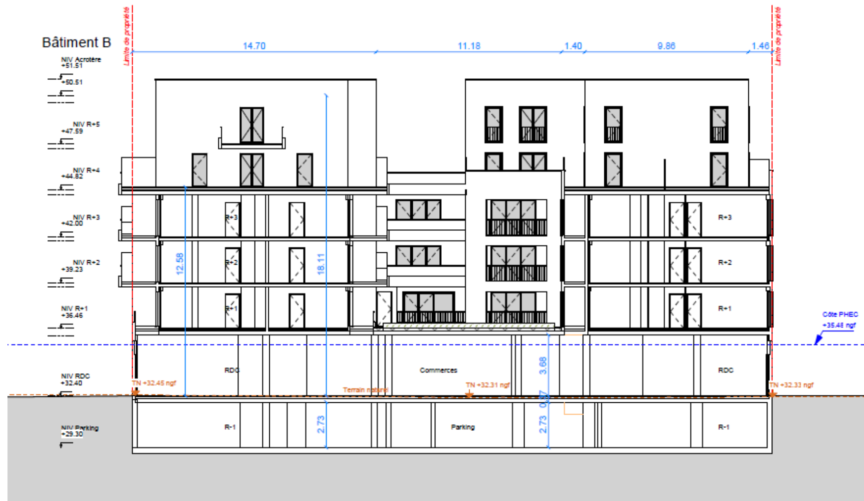
Figure 15 : Coupe transversale – Bâtiment B (Lot 2)
